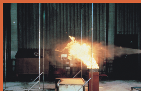
ULTRA-SAFE 620 喷射在丙烷燃烧器上, 仅仅使丙烷燃烧器的火焰倾斜, 而ULTRA-SAFE 620 本身并未点燃
