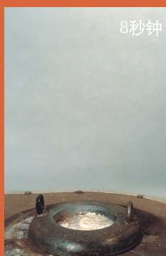
ULTRA-SAFE 620 在熔融铝表面上的燃烧情况 (25ml液压油在20kg铝熔体上)
