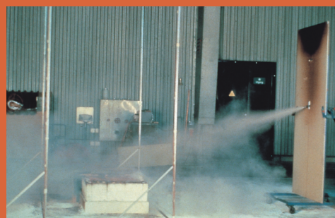
ULTRA-SAFE 620 喷射在热金属表面 ( 700℃ )
