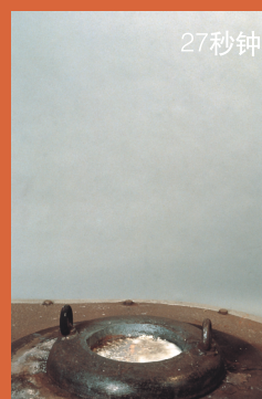
ULTRA-SAFE 620 在熔融铝表面上的燃烧情况 (25ml液压油在20kg铝熔体上)
