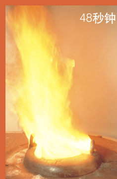
普通液压油在熔融铝表面上的燃烧情况 (25ml液压油在20kg铝熔体上)
