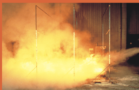
普通液压油喷射在热金属表面 ( 700℃ )
