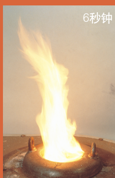
普通液压油在熔融铝表面上的燃烧情况 (25ml液压油在20kg铝熔体上)
