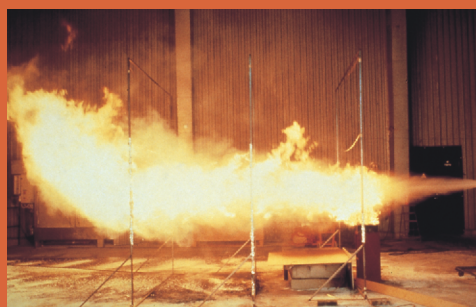
普通液压油喷射在丙烷燃烧器上产生大火
