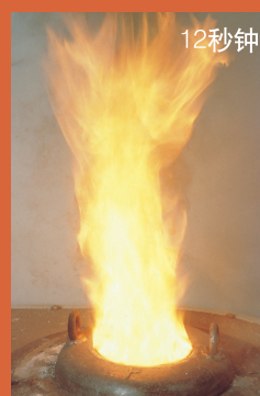
普通液压油在熔融铝表面上的燃烧情况 (25ml液压油在20kg铝熔体上)
