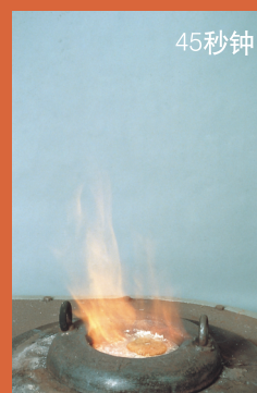
ULTRA-SAFE 620 在熔融铝表面上的燃烧情况 (25ml液压油在20kg铝熔体上)
